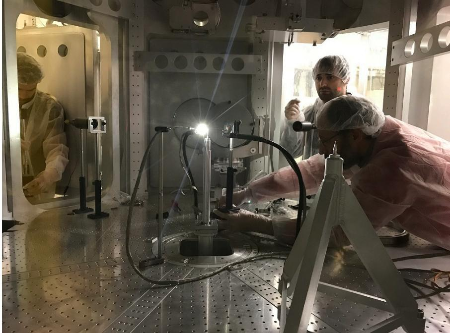
*Tests de dispositif optique d'alignement de cible à l'intérieur de l'enceinte SFA d'Apollon. De gauche à droite, K. Burdonov, V. Lelasseux, J. Fuchs, du groupe SPRINT du LULI. La monture de la parabole de focalisation du faisceau F2/1 PW est visible dans l'arrière-plan.*
